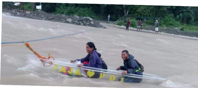
Notlösung, um bei Flut den Fluss zu überqueren. Es wurde ein starkes Seil gespannt, daran wird das kleine Boot über den Fluss gezogen.
